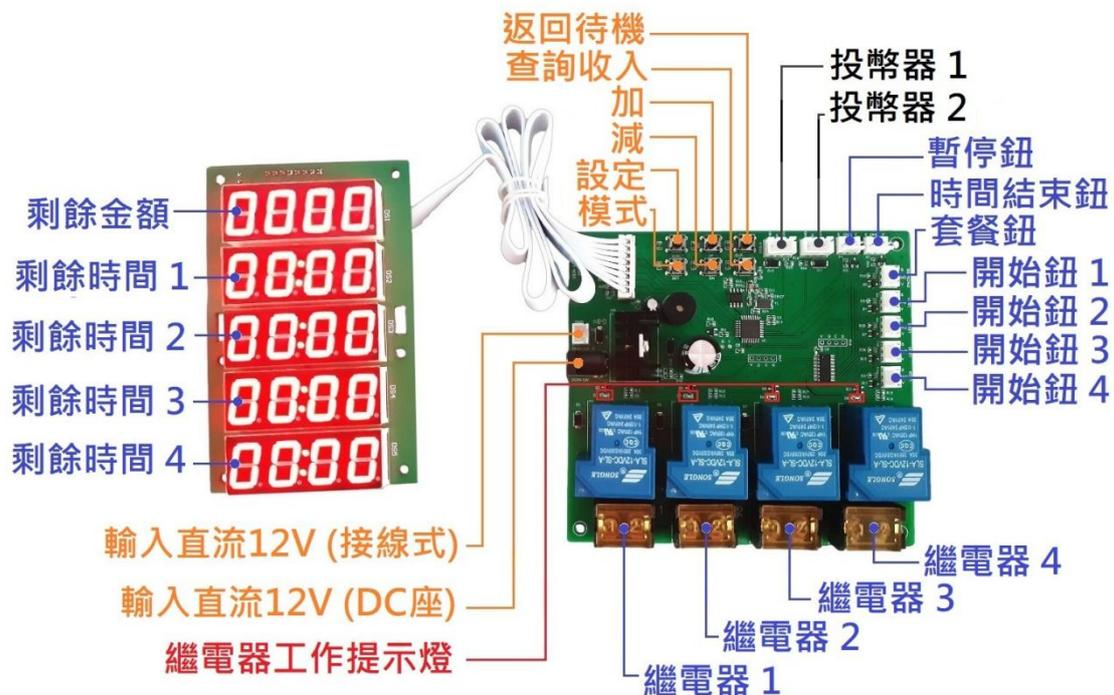
**暫停鈕：**時間倒數時→按暫停鈕→時間停止倒數，繼電器停止工作→再按→繼續倒數及工作
