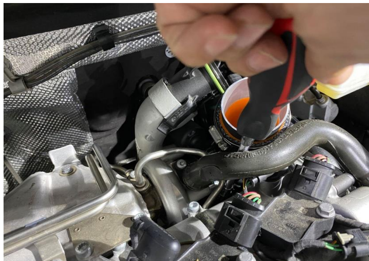
Figure 13: 鎖緊MST轉座和管路上的管束
