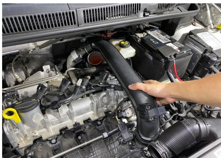
Figure 14: 回復安裝原廠渦輪管，插回感應器接頭
