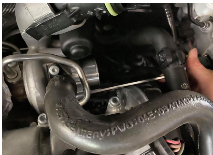
Figure 11: M6加長螺絲，使用內六角板手，將MST轉座和渦輪對鎖
