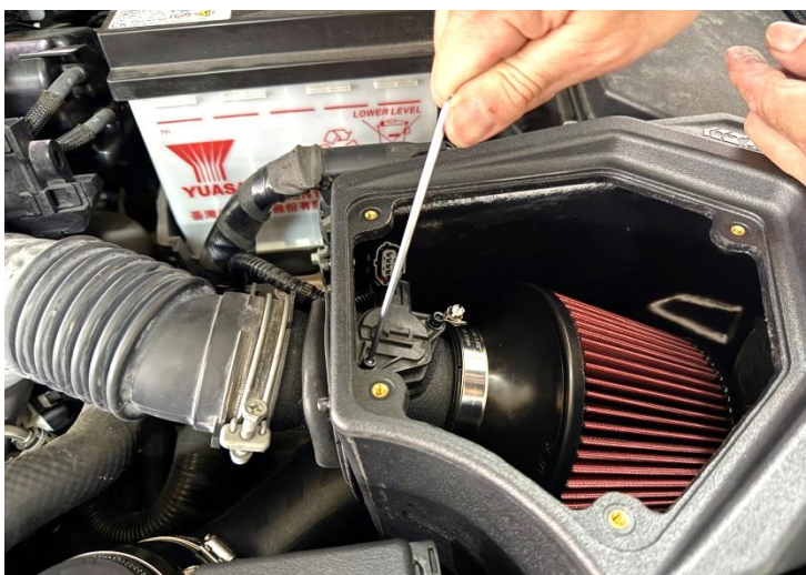
步驟 15: 安裝MAF感應器至進氣管上 使用M4螺絲鎖緊
