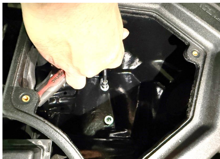
步驟 11: 使用M6螺絲固定集氣箱
