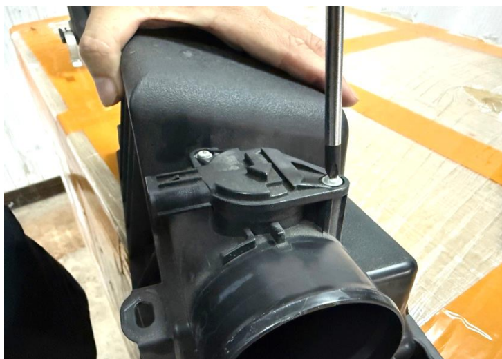
步驟 14: 用十字起子鬆開MAF螺絲 取下感應器
