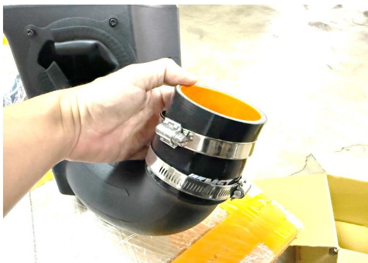
步驟 9: 安裝70-76直管矽膠至集氣箱上
