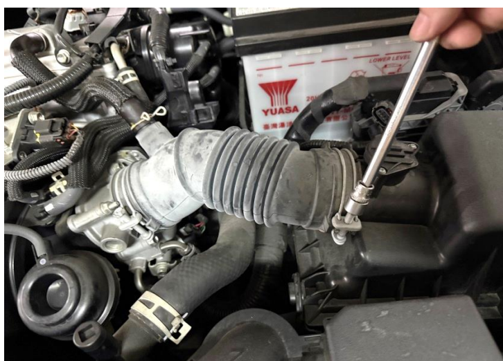
步驟 3: 轉鬆集氣箱上的橡膠管管束
