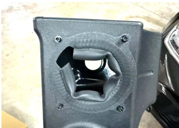
步驟 8: 安裝集氣箱隔熱擋板 注意孔位方向
