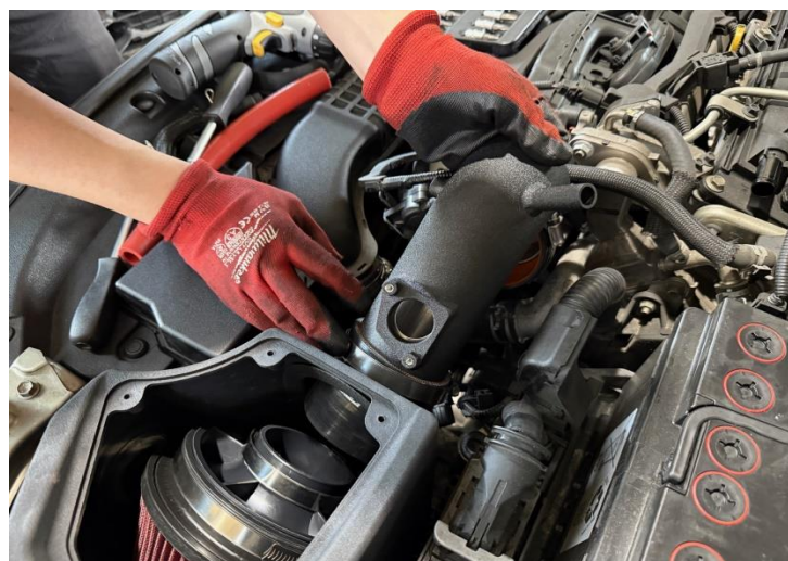
步驟 20: 安裝MST進氣管，濾心跟進氣管連接
