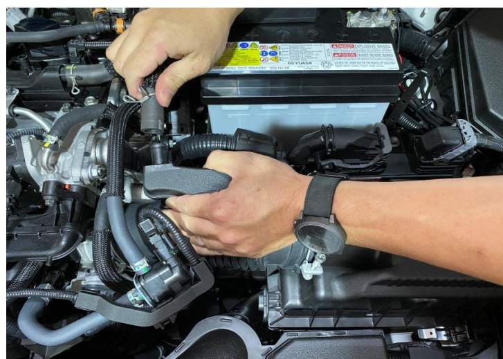
步驟 3: PCV管路從原廠進氣管上拔除
