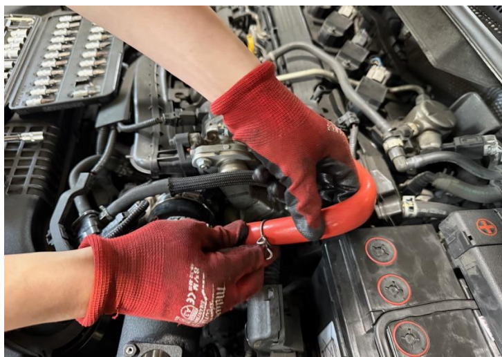
步驟 21: 安裝PCV真空管和連接MAF接頭
