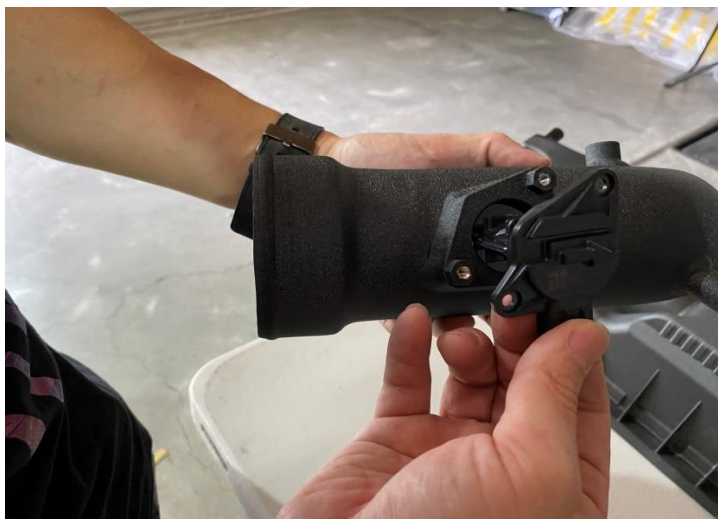
步驟 11: 將MAF安裝至MST進氣管路
