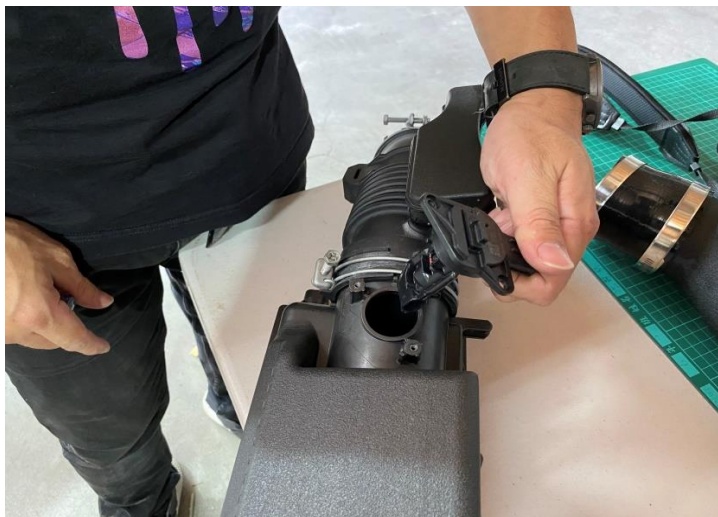
步驟 10: 從原廠進氣管上移除MAF
