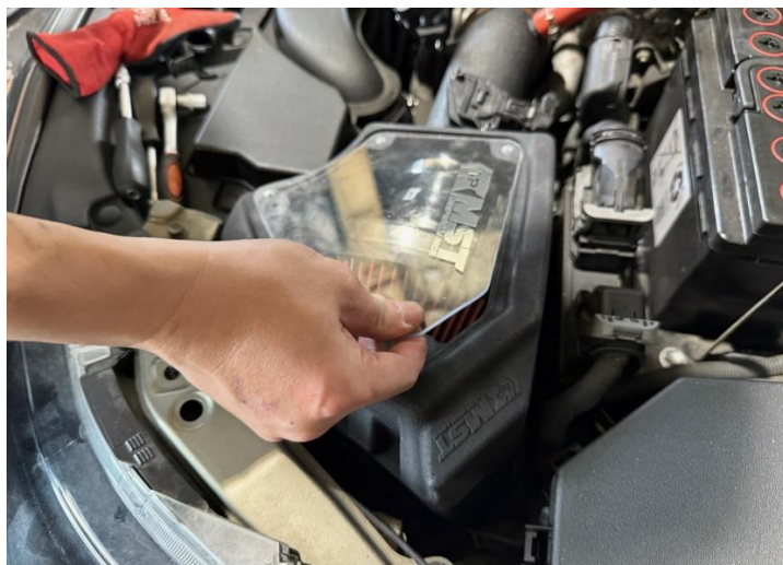
步驟 28: 安裝MST集氣箱上蓋鎖緊螺絲
