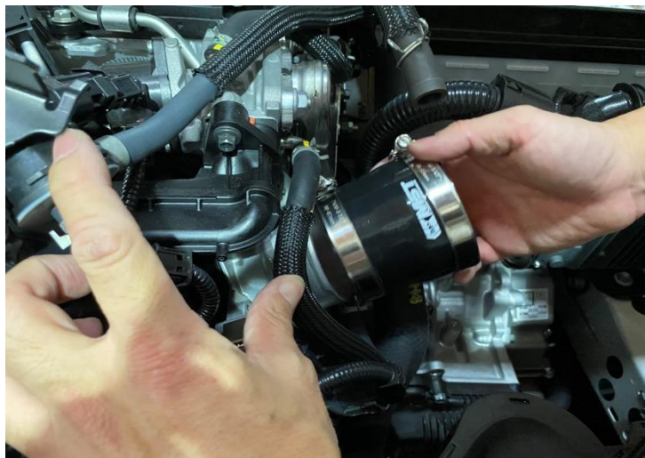
步驟 13: 安裝70-76 15度矽膠管至節氣門，注意角度
