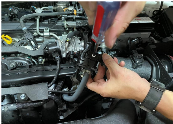
步驟 22: 鬆開原廠EVAP支架上的螺絲
