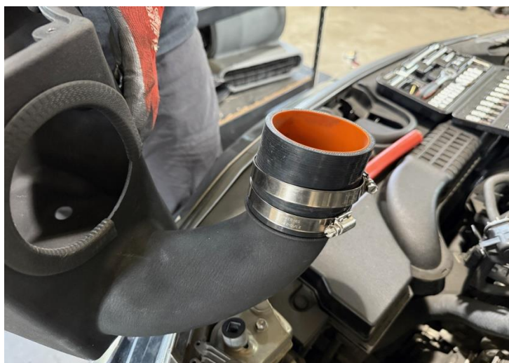
步驟 15: 安裝70-70直管矽膠至集氣箱上
