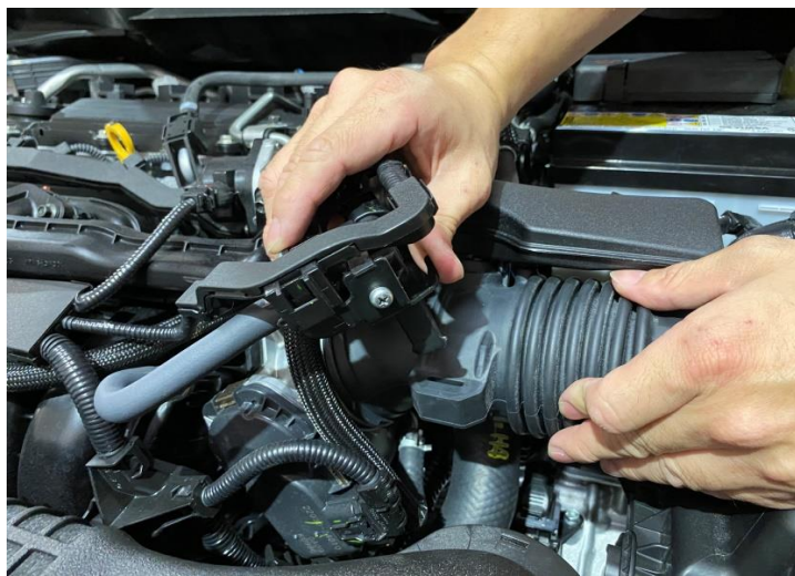
步驟 4: EVAP從原廠進氣管路拔除
