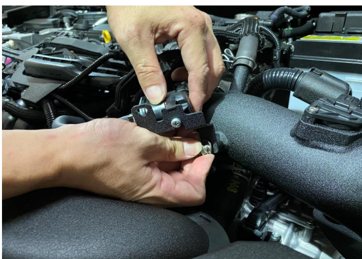
步驟 26: 固定EVAP支架到進氣管路上
