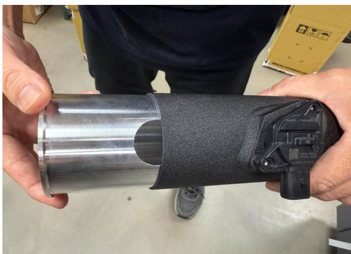
步驟 12: 將MAF感應器套管裝入MST 鋁管內
