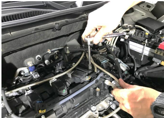
Figure 19. Remove the bolt.
