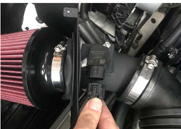
Figure 24: 連接MAF接頭
