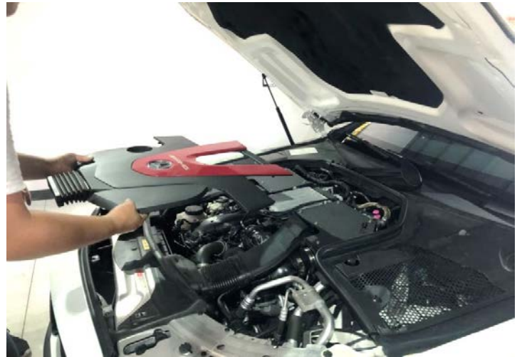
Figure 19: Install the engine cover. 圖十九: 安裝引擎蓋。
