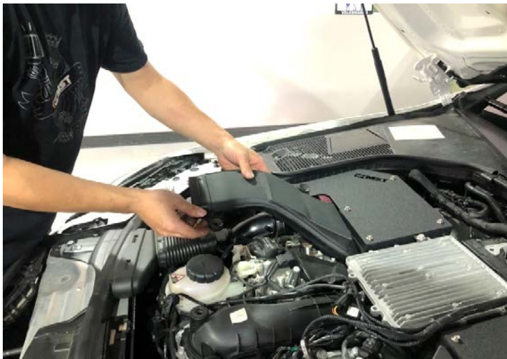
Figure 17: Install the air ducts. 圖十七: 安裝風管。
