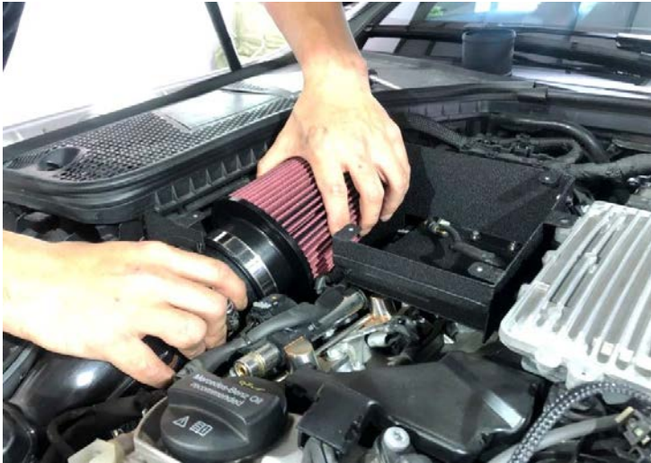
Figure 13: Install the air filter. 圖十三: 安裝空氣濾器
