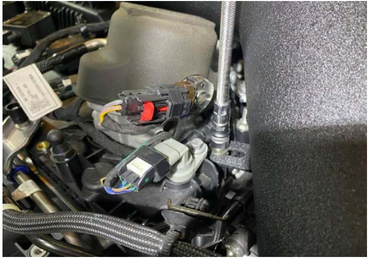
Step 24. Use 10mm socket and secure the induction pipe with M6 nut 步驟 24: 使用10號工具鎖上M6固定螺母
