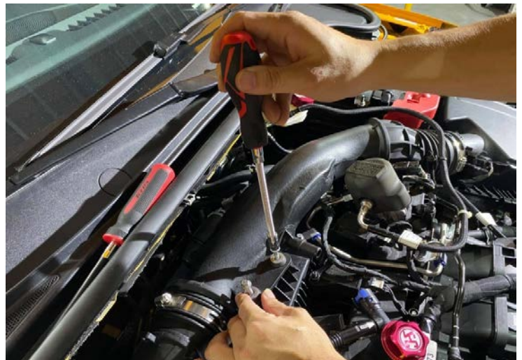
Step 5. Use 8mm socket to remove the stock induction pipe retaining bolts 步驟 5: 使用8號六角工具取下進氣管固定螺絲
