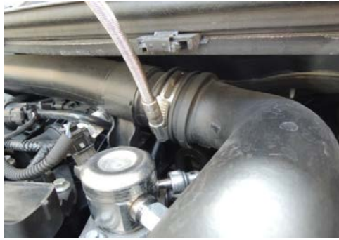
Figure 2: Loosen the clamo on the tube using 7mm nut driver. 使用 7mm 螺絲起子鬆開管子上的夾子
