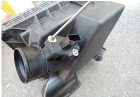
Figure 7: Loosen the 2 screw holding in the MAF sensor using T20 torx bit. 使用 T20 torx 鑽頭鬆開固定在 MAF 感應器中的 2 個螺絲
