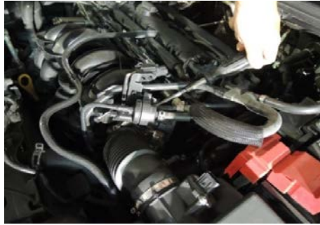
Figure 2: Loosen the clamp on the tube using 7mm nut driver. 使用 7mm 螺絲起子鬆開管子上的夾子
