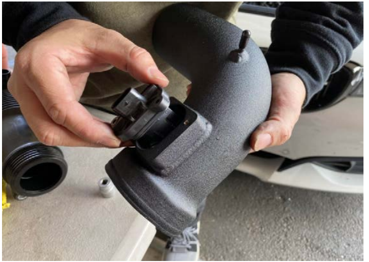
Figure 23: Install the MAF on tube.將 MAF 安裝在管上
