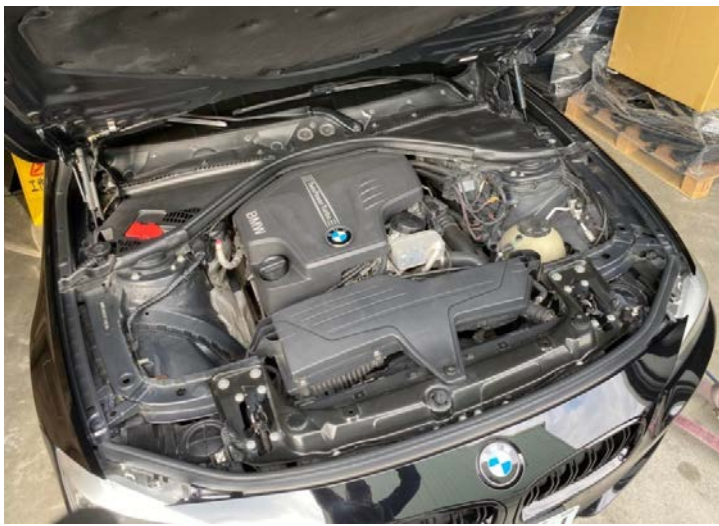
Figure 1: Stock air box. 原廠引擎室
