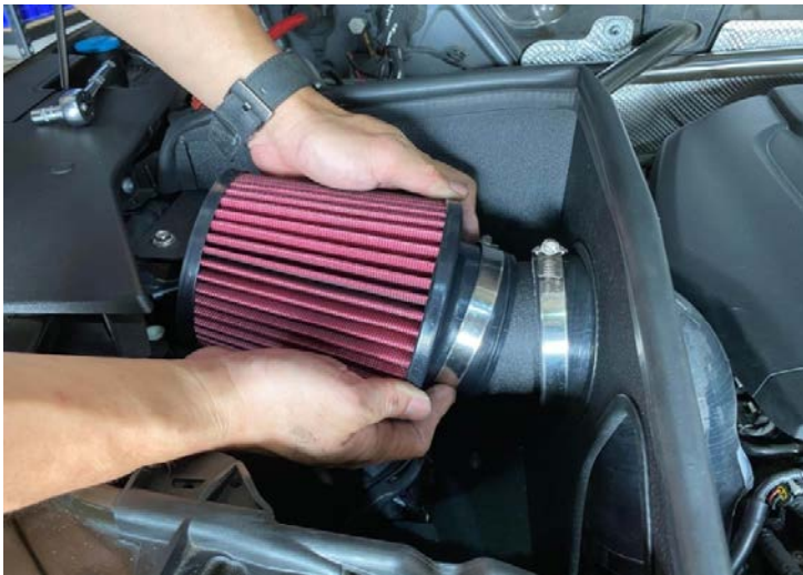
Figure 14: Install the MST air filter. 安裝 MST 空氣濾清器
