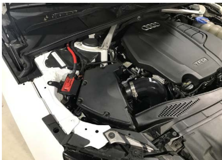
Figure 1: Stock factory airbox. 原廠引擎室
