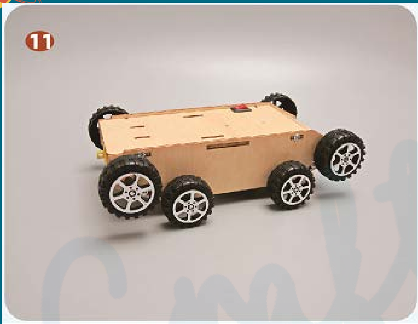
如图将车轮安装在车身两侧， 中间两个小轮，两端两个大轮
