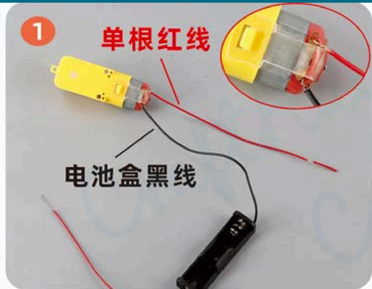
如图将电池盒黑线和单根红导线连接在马达上
