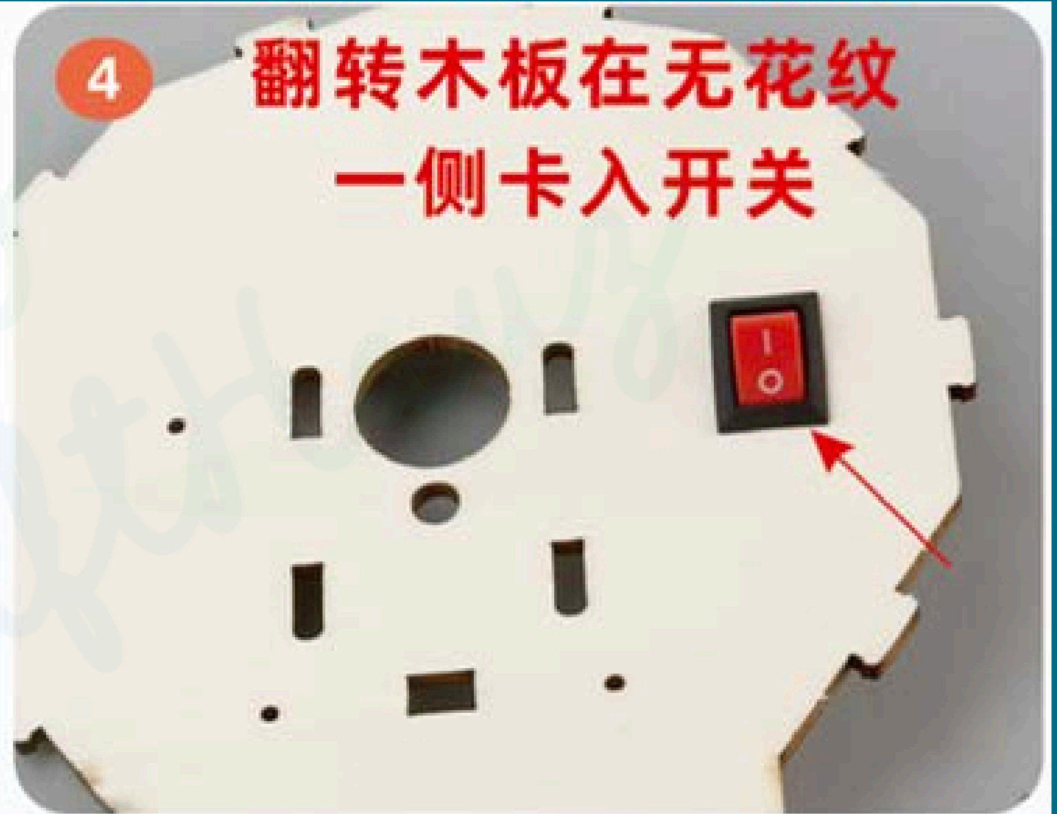
如图在木板无花纹一侧安装开关
