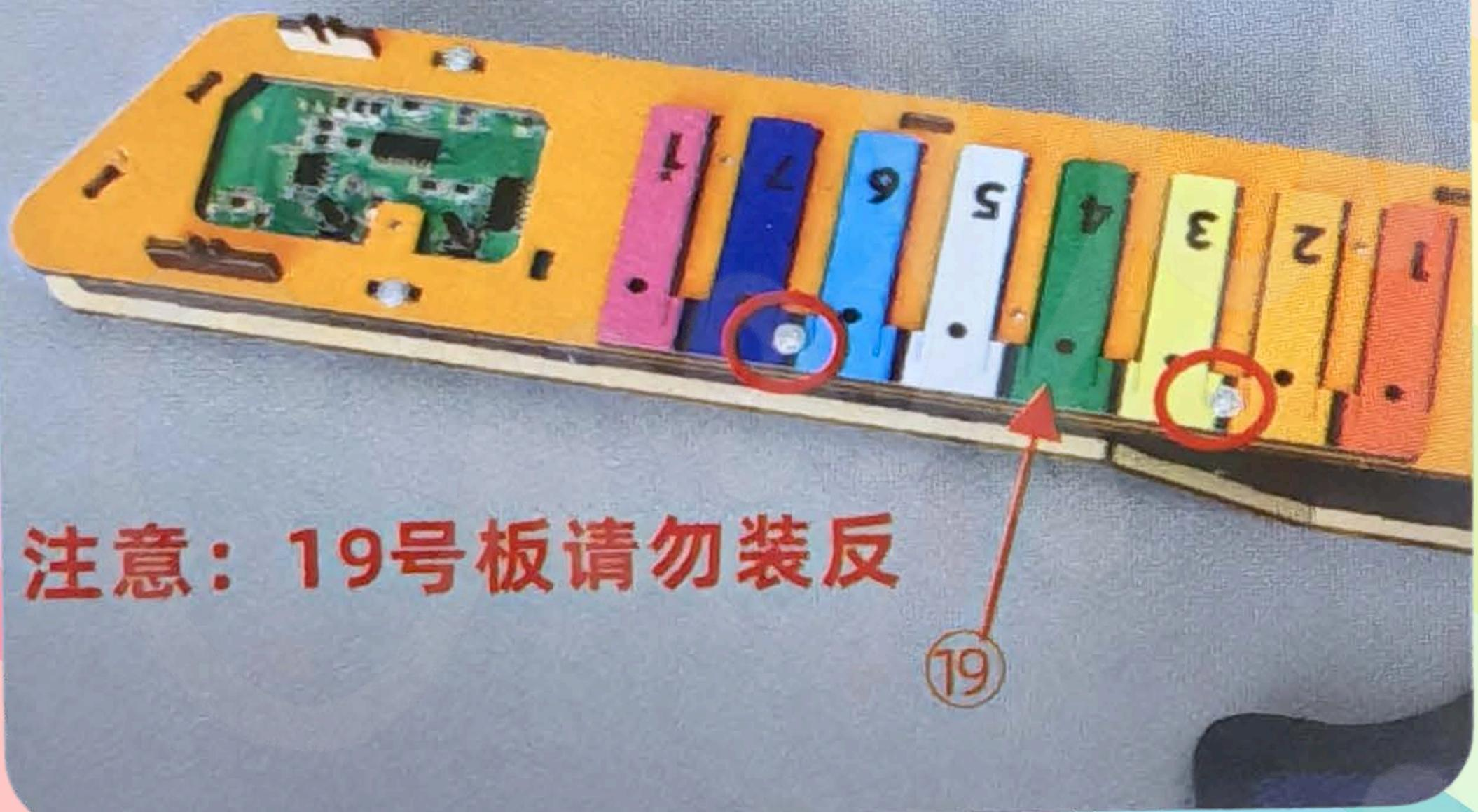
Seperti yang ditunjukkan dalam gambar, gunakan dua skru 8 mm untuk mengikat papan No. 19.
