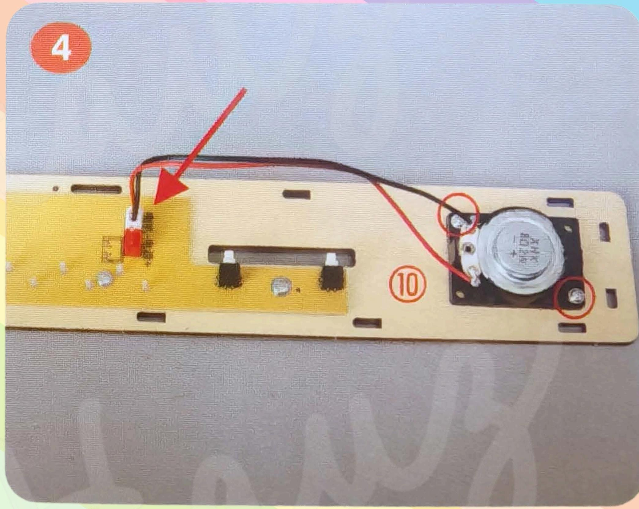
Gunakan dua skru 6 mm untuk memasang pembesar suara pada papan No. 10 (seperti yang ditunjukkan dalam gambar).
