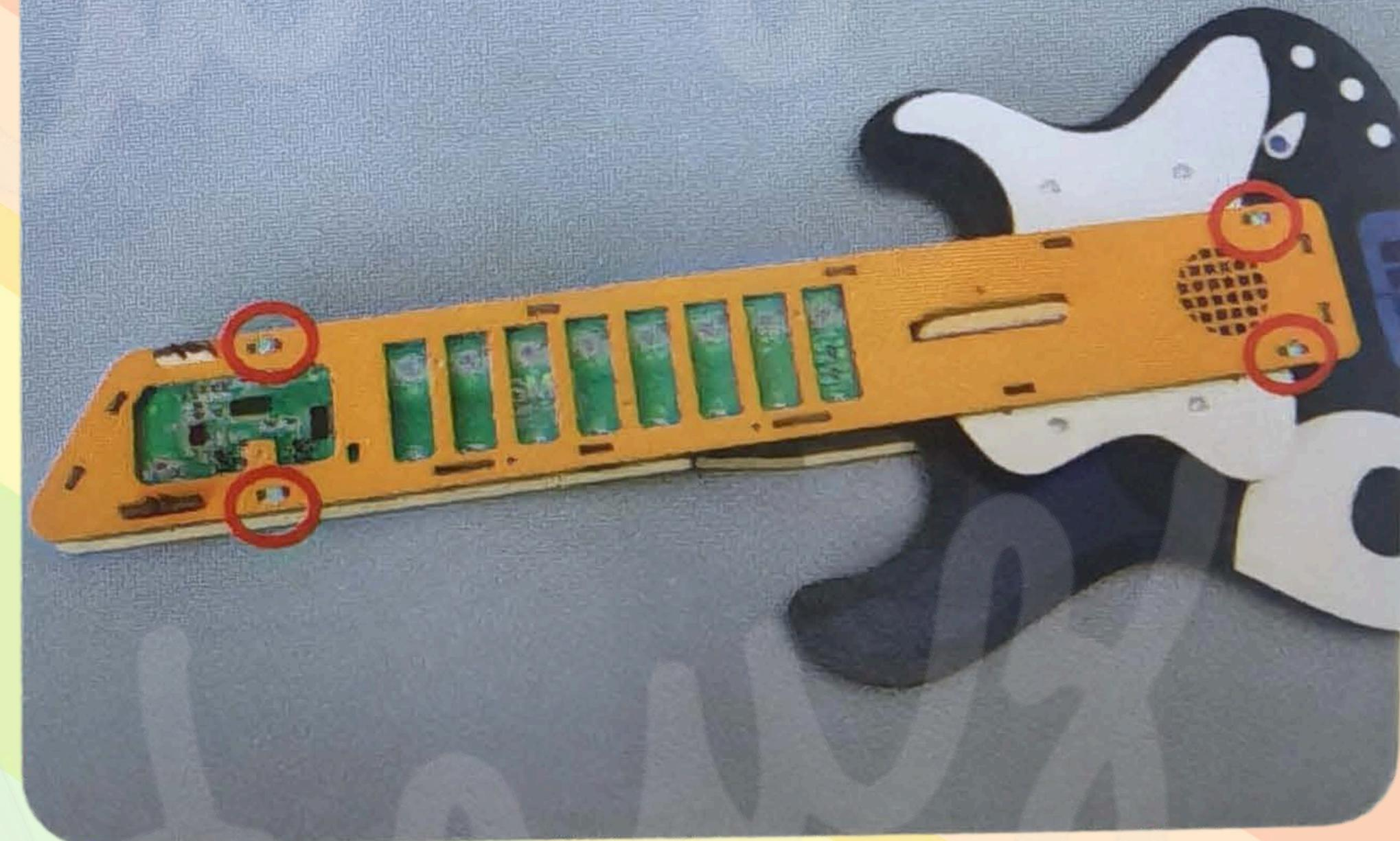
Seperti yang ditunjukkan dalam gambar, terbalikkan pemasangan gitar elektrik ke bahagian hadapan dan ikat dengan empat skru 6 mm pada lubang skru yang ditandakan.
