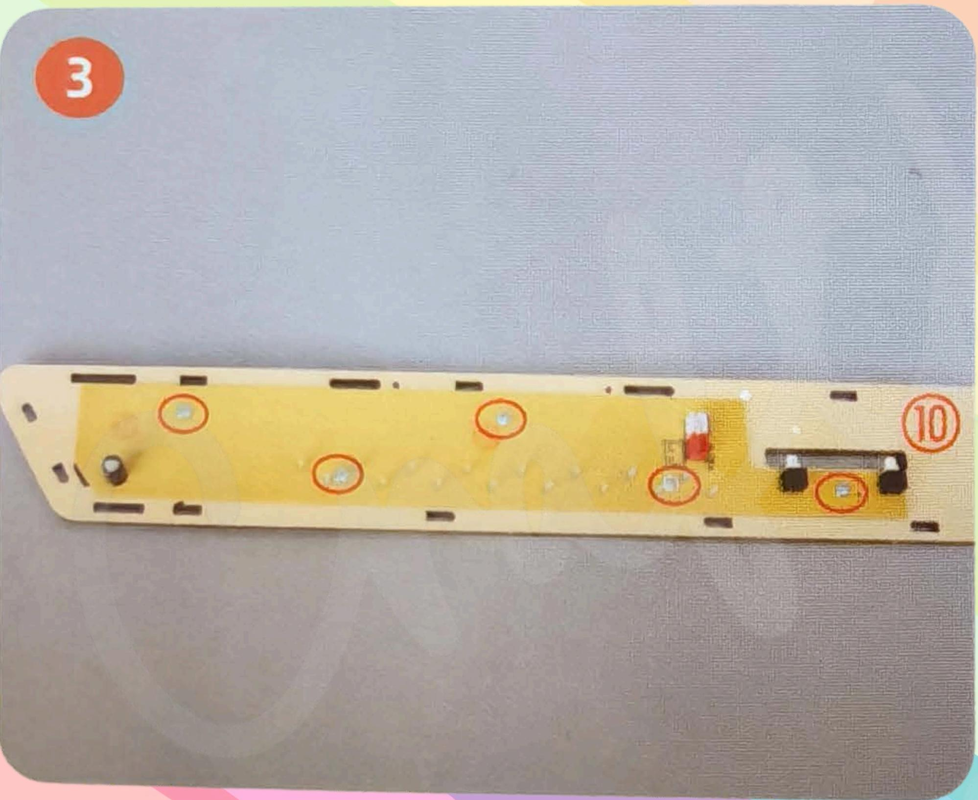
Gunakan lima skru 4mm untuk memasang papan litar pada papan No. 10 (seperti yang ditunjukkan dalam gambar).
