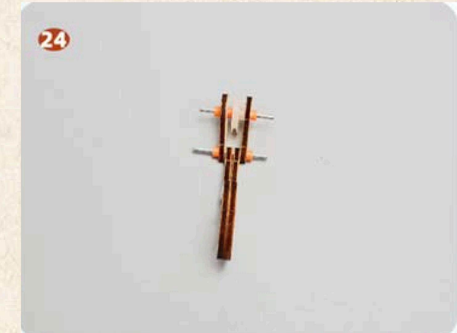
先把白色皮带轮安装在30的光轴上，一侧用轴套，然后用两块20号板依次安装在两侧
