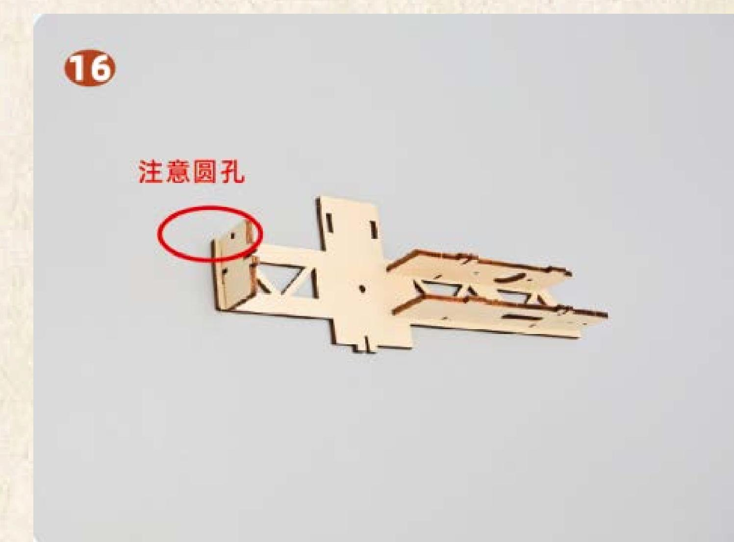
用7mm螺丝将15号板固定在11号板上
