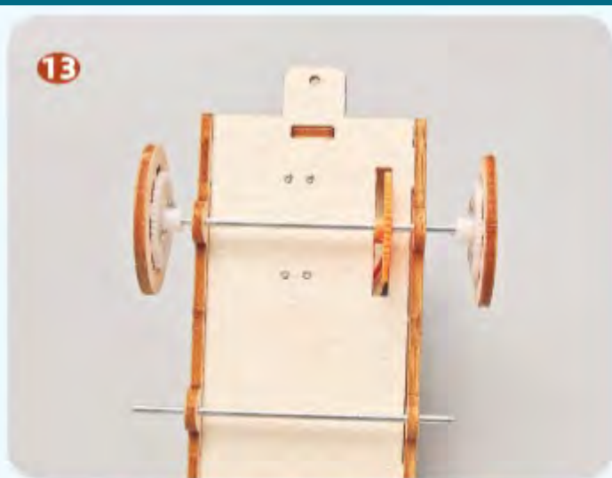
如图将白齿轮（车轮）安装
