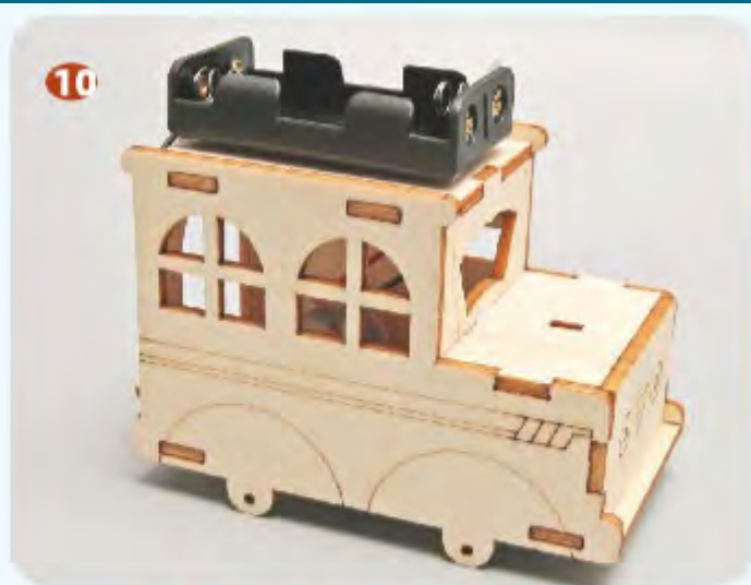
如图将另一块1号板安装， 电池盒用双面胶粘贴
