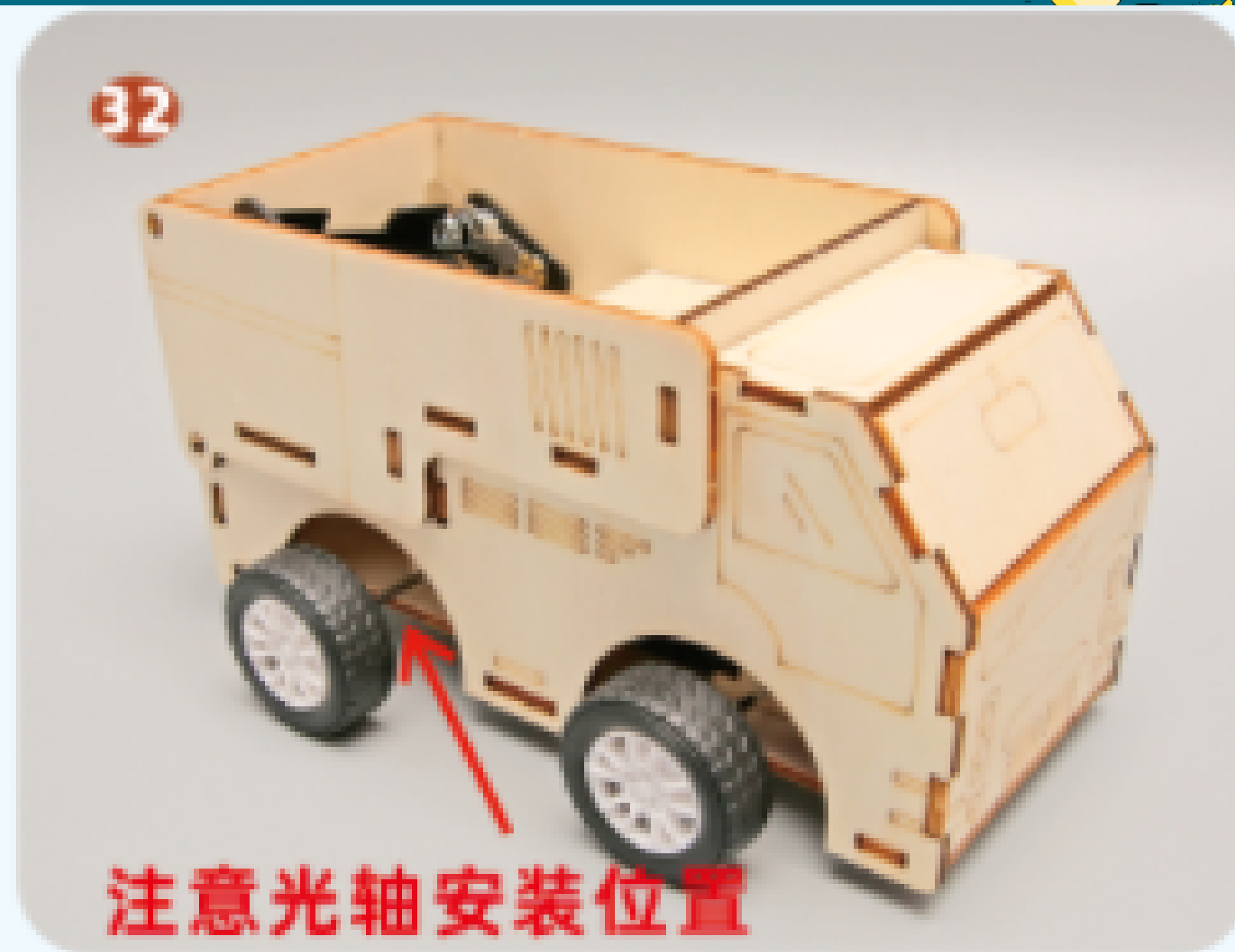
如图安装光轴和前后车轮，组装完成。
